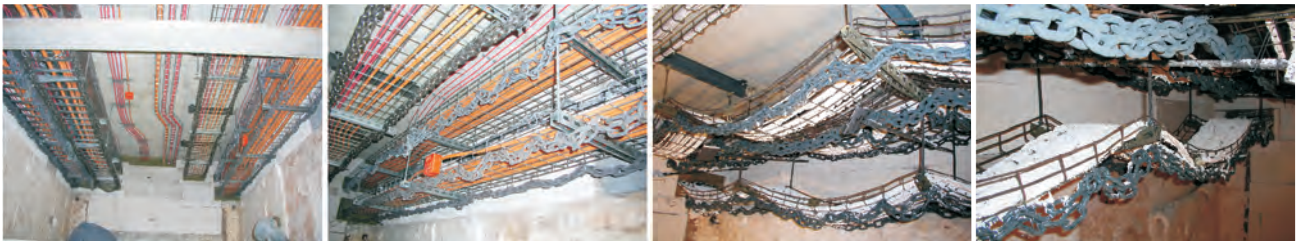
Вид перед и после проведения испытаний на огнестойкость кабельной трассы, выполненной из проволочных лотков
